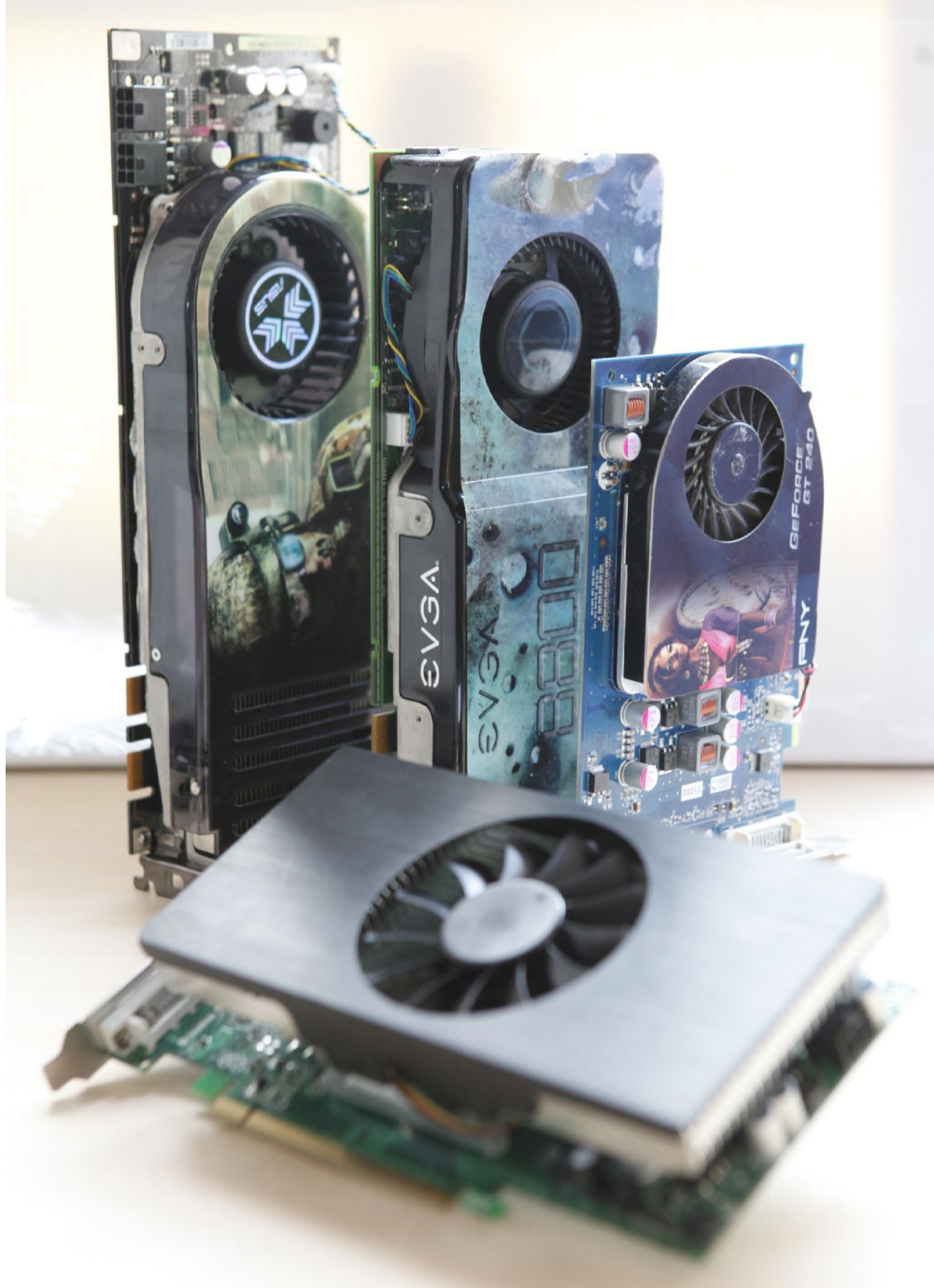
Hylättyjä mutta tehokkaita näyttöohjaimia. Kuvassa 8800 GTX, 8800 GTS, GT 240 sekä 9800 GT.
